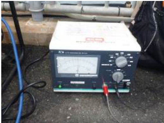
写真-4.2 絶縁抵抗測定装置
