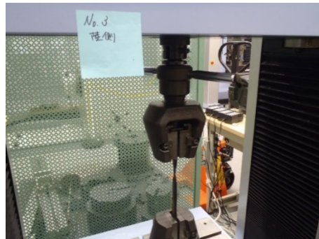
写真-6.2 保護カバーの試験片と試験状況
