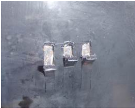
写真-5.5 ピール強度測定部（杭 No.32）
