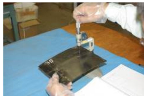
写真-5.9 被膜厚さ測定状況
