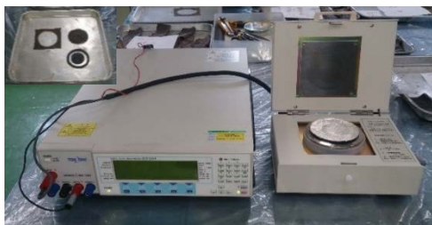
写真-6.1 ペトロラタム系防食材の試験片と試験状況
