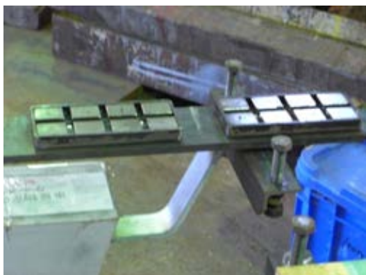
写真-8.1 フラットバー上に固定された磁石部
