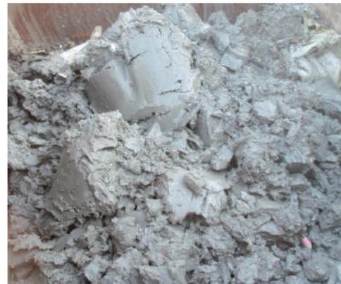
付録写真-2.7 遮水層からの掘削土砂。廃棄物が混じっている。
