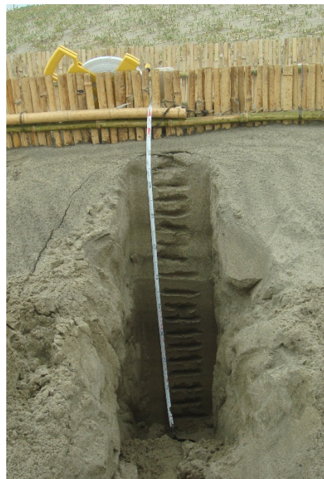
写真-3 堆砂垣前面のコアサンプル採取状況
