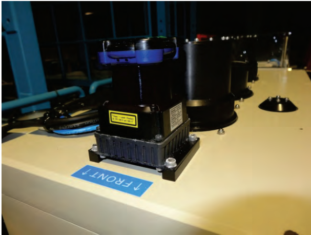
写真-2.11 測域センサ 北陽電機株式会社UTM-30LX-EW
