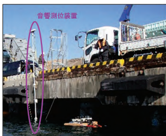
a) 音響測位の例 (機器は水中に設置)
