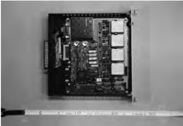
図-6 ERS-F 型強震計の記録装置のメインユニット
