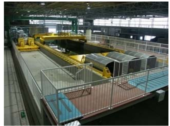
図- 3.3: 油回収実海域再現水槽
