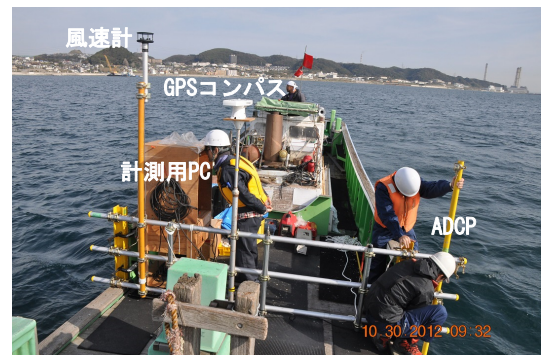
図- 4.10: 風況及び流況データ計測方法
