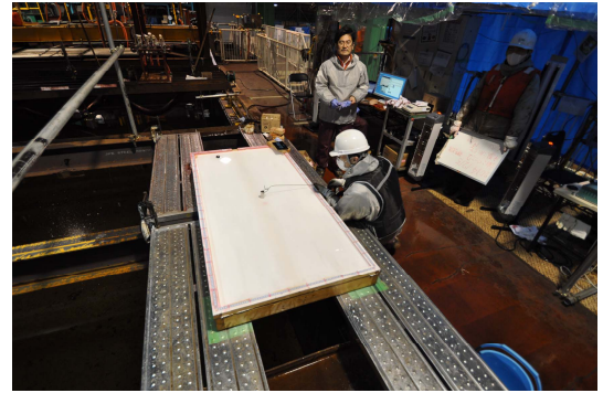
図- 3.6: 小型水槽での油投入の様子
