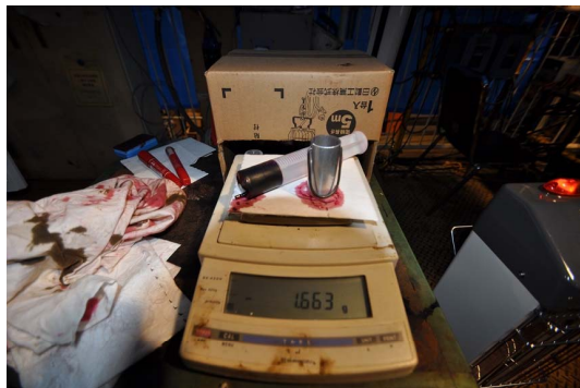
図- 3.5: 油投入量の測定の様子
