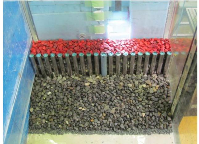
写真-2.1 港内側の設置状況(杭方式)
