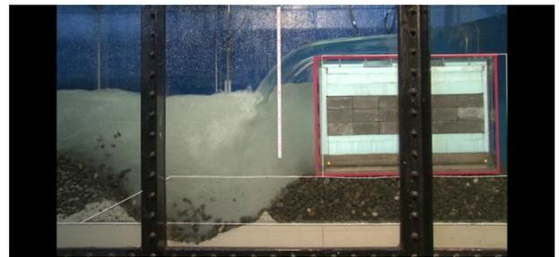
K-N-1\_2ケーソン倒壊直前(実験開始355sec経過後)
