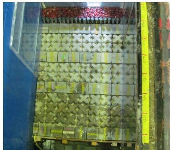
写真-2.10 港内側洗掘防止の状況(O-PB)
