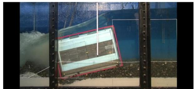
K-N-1\_2ケーソン倒壊直後(実験開始370sec経過後)
