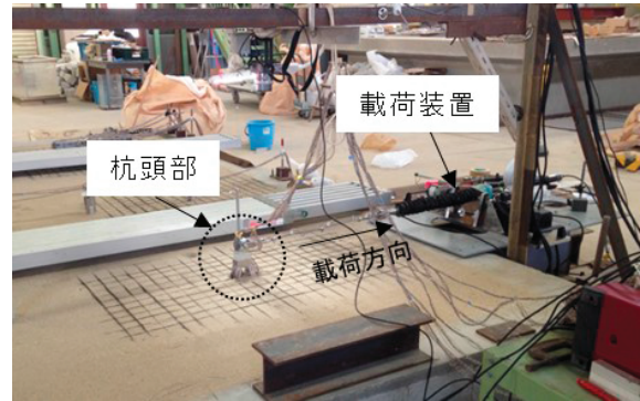
図-3.10 模型地盤と周辺装置の様子 (G-04)
