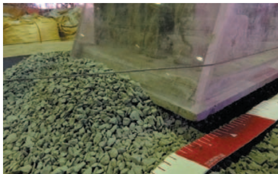
写真- 3.3 目地洗掘幅 12.5cm での滑动後の様子
