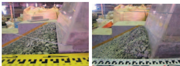
写真-3.1 滑動後の様子(左：台形ケーソン引張位置+35mm，右：+175mm)
