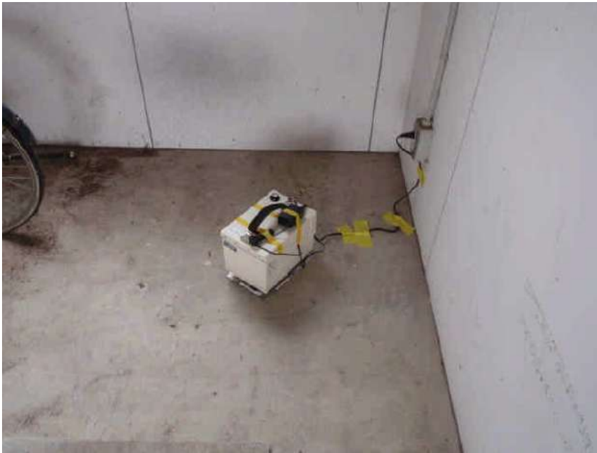
写真-3.3 熊本空港における地震計設置状況（2010 年）（その 3）
