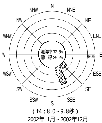
付図 - B.2.24 苫小牧 波高・波向別出現頻度図 ( f2 , f3 , f4 , f5 , 全周期帯 )
