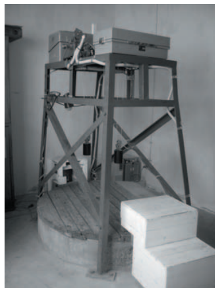
図-5.9 久里浜の潮位計の概観
