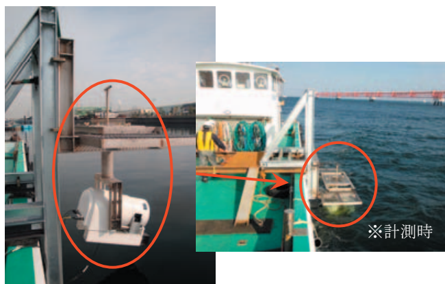
写真-3.1 4-DWISS水中部及び船舶への取付ジグ
