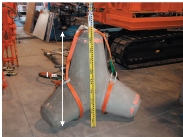
写真-2.2 視認対象とした消波ブロック (0.5 ton)
