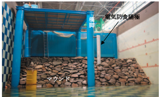
写真-2.1 水中作業環境再現水槽内の様子
