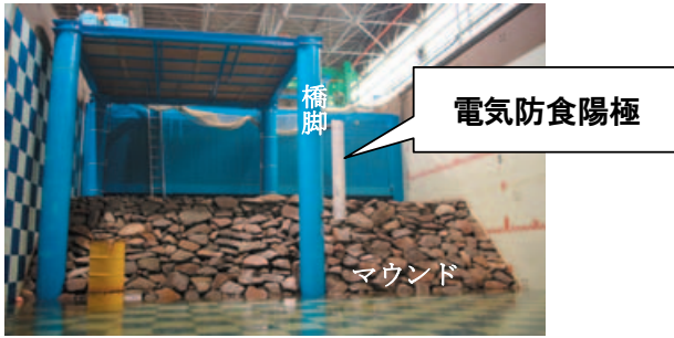
(a) 視認対象とした電気防食陽極の設置状況
