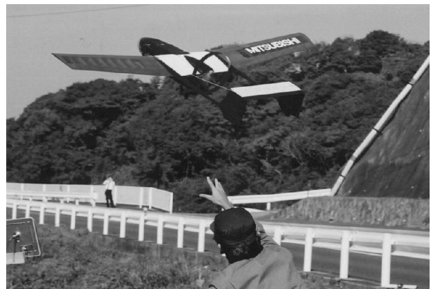
図-30 小型UAVの離陸作業
