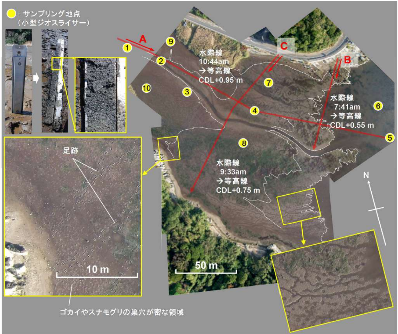
図-31 小型UAVから撮影した干潟表面画像（合成）とMASWの測線および小型ジオスラサー調査位置
