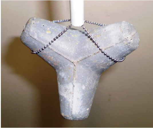
写真-22 摩擦が無い状況でのブロック模型吊り上げ
