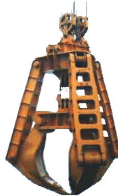
写真-2 3本爪式ブロック把持装置
