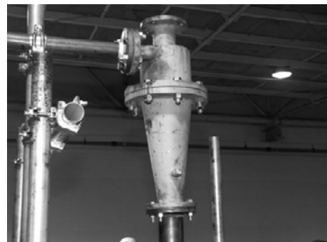
写真-4 サイクロン式気液分離器
