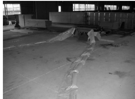
写真-3 オイルブーム接続
