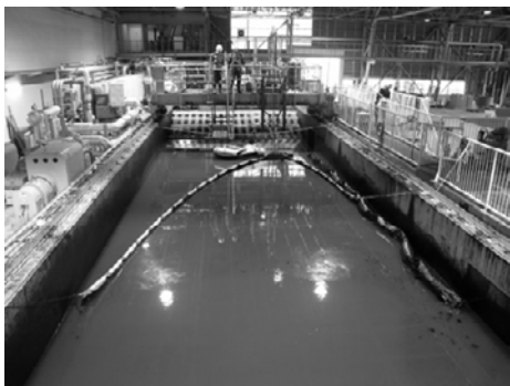
写真-6 実験模型オイルブーム展帳風景
