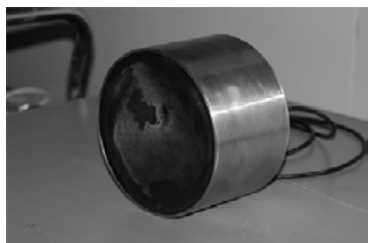
図-4 非接触肉厚測定用超音波送受波器
