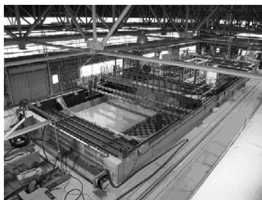
図-18 水中作業環境再現水槽
