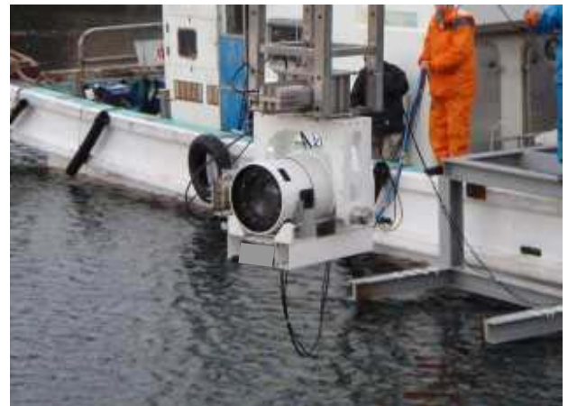
写真-7 超音波式三次元映像取得装置を船舷に取り付ける様子。
