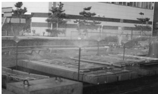
写真-5 海水シャワー暴露試験の状況
