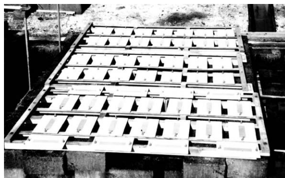
写真-2 暴露状況 (旧塗膜再現時)
