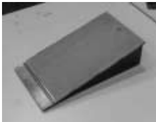
図-2.2 試料容器底板 ( k_b = 0.25 用)
