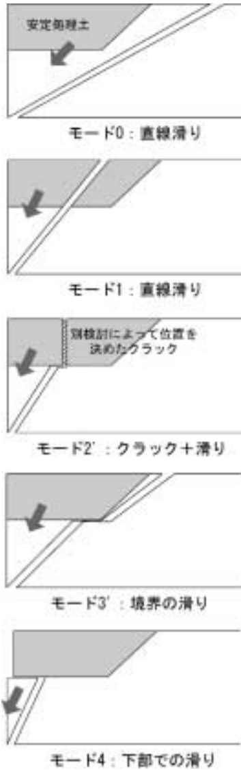
図-3.3 本研究で仮定した破壊モード
