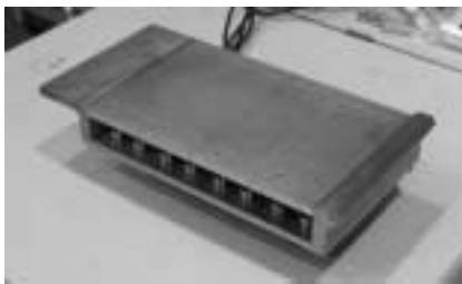
図-2.3 土圧測定用擁壁
