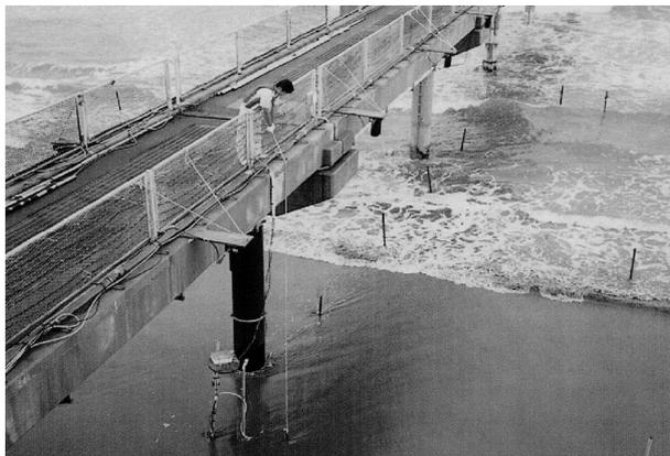
写真-D. 3 海上部での地形断面測量の様子
