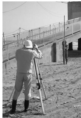
写真-D. 4 陸上部での地形断面測量の様子
