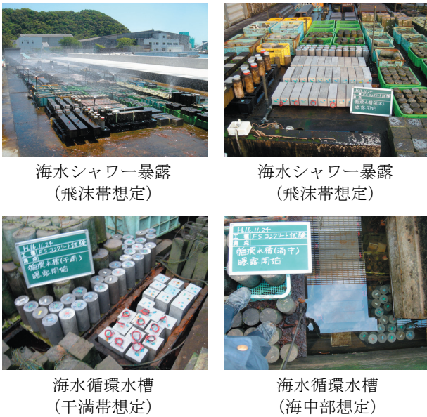
写真-9 暴露状況
