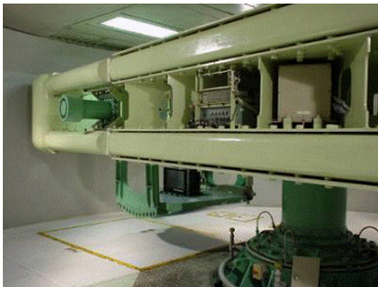
図-3.1 遠心模型実験装置
