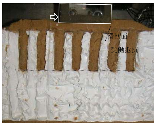
図-3.36 浮き型改良地盤の変状（ケース9）
