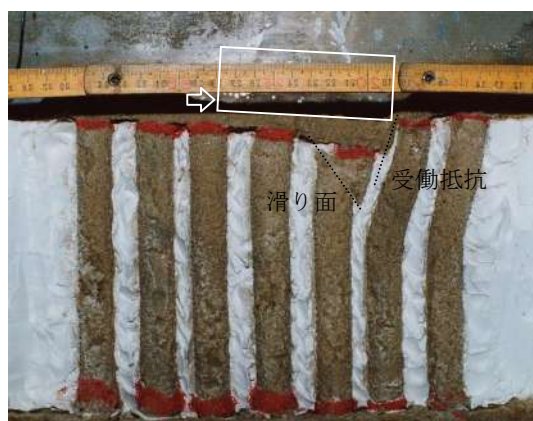
図-2.3 着底型改良地盤の変形状況 (No.5) (寺師・北詰, 1990)
