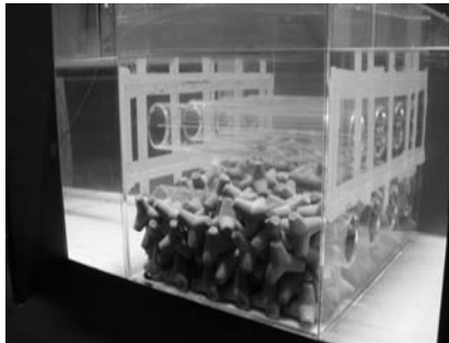
(b) 水槽内への設置状況 (アクリル模型内のブロックは重りとして使用している)
