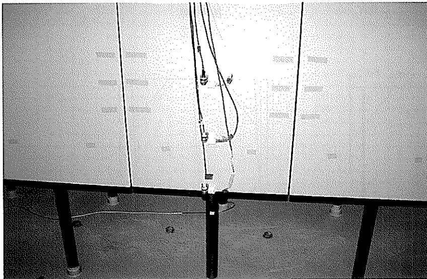
写真-3.7 制震版の水圧計および加速度計の設置状況
