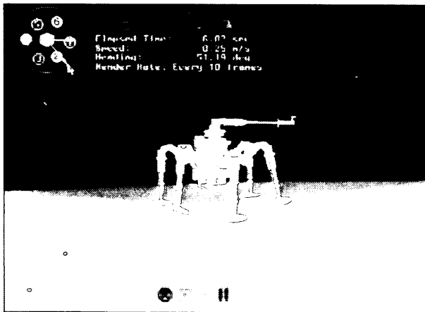
図-5.5 DynaMechs software packageを用いた 拡張ウェーブ歩容のシミュレーション
