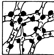
図一12 セメントゲル中での顔料粒子 (モデル図)
