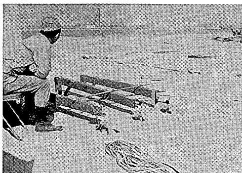
写真 A-2 水平載荷試験変位測定状況
