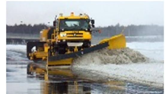
空港除雪車両の走行・運転操作データを収集・分析し、自動化可能な定型的な操作を抽出する。自動化/省力化技術導入時の省力化等の効果を評価する手法を開発する。
