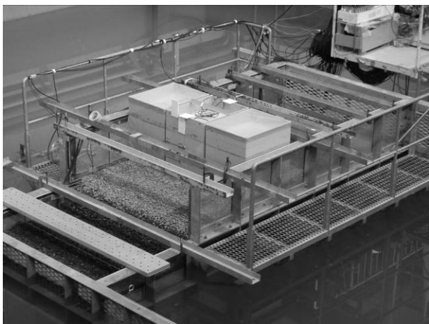
c) 捨石マウンド製作とケーソン据え付け
