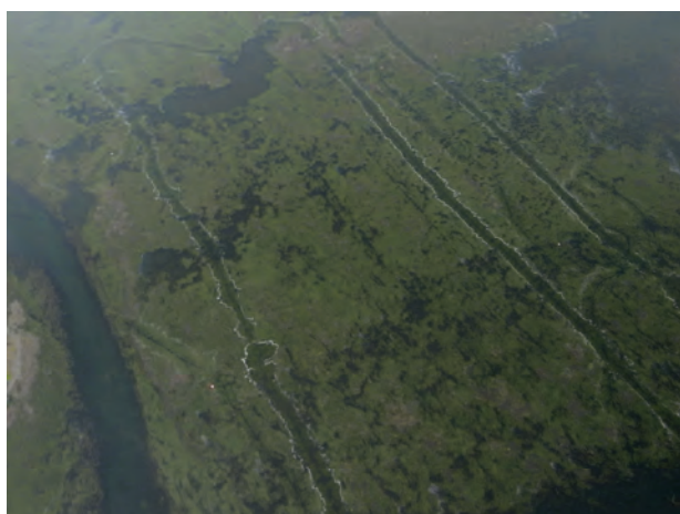
図-1 気球からの撮影例。斜めから撮影されるため画像がひずんでいる。撮影に使用した船の航跡後が筋のように見えている。
