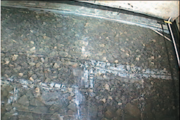
(a) 計測開始 165s 後 (推定: 洗掘スタート)
