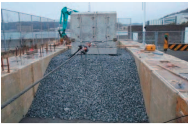
図-2.5 気中におけるケーソンの引張試験の模式図
