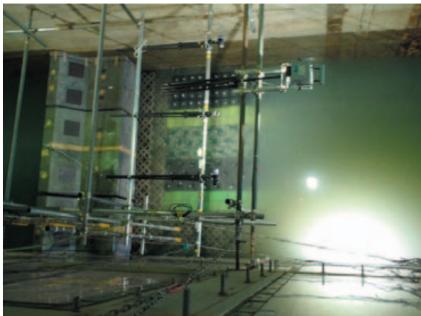
写真-4.4 実験後の被覆材の様子(ケース OM-1-1)
