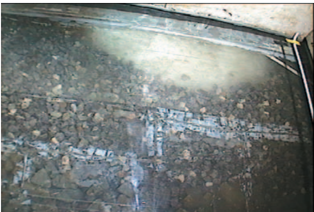
(c) 計測開始 175s 後 (ほぼ最大洗掘深に到達)
