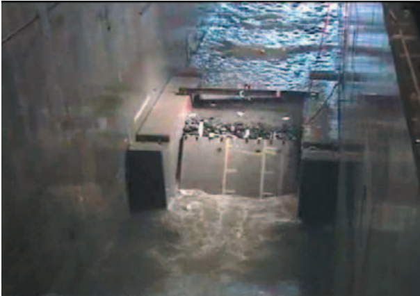
写真-3.6 5波目が作用したことで波返し部が分離
