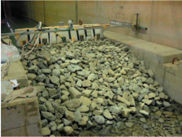
写真-2.3 実験模型設置状況（背面）
