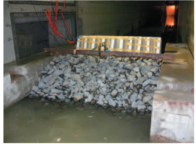
写真-3.16 波高0.7m作用後の裏込部の様子
