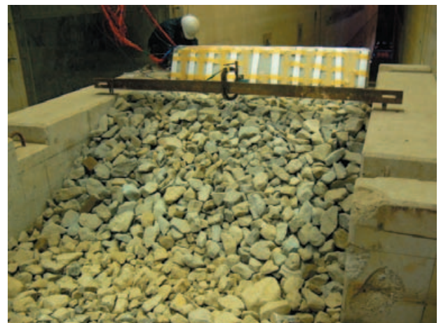
写真-3.14 ケース D6-5 実験前の裏込部の様子
