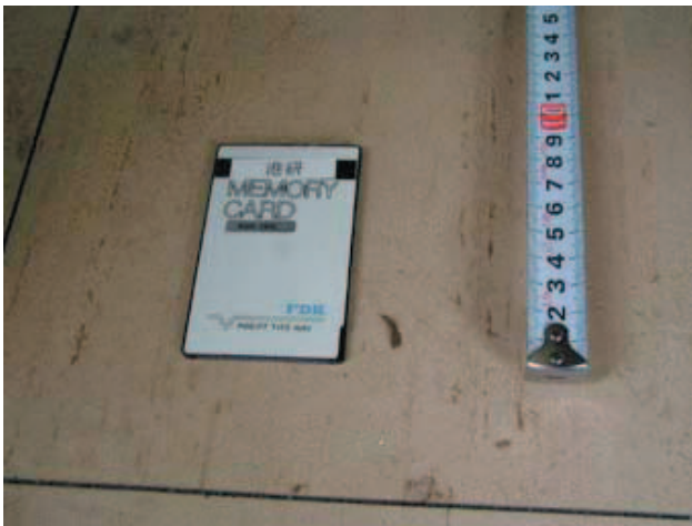
図-13 ERS-G/GV 型強震計の IC カードメモリ
