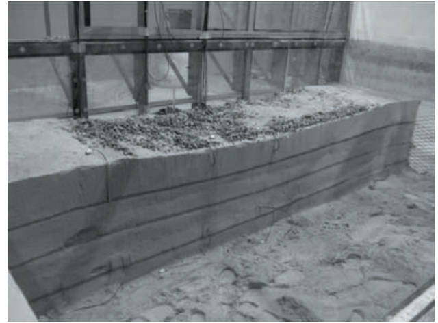
写真-4 色砂の変形状況 （南側アクリル壁から85cm北側）
