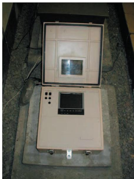
図-16 SMAC-MDU 型強震計の外観
