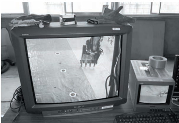
図-5.6 TV モニタによる遠隔操作画面
