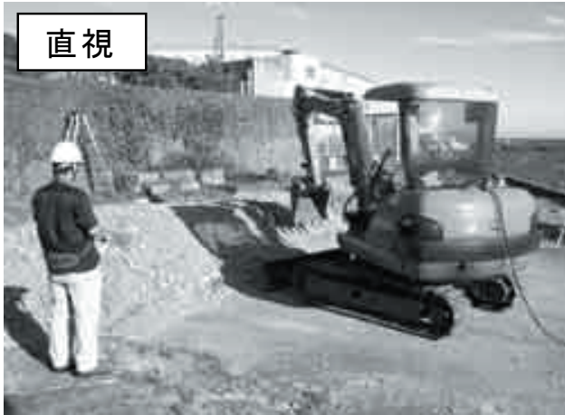
図-4.65 立体指示動作実験 無線リモコン操作状況
