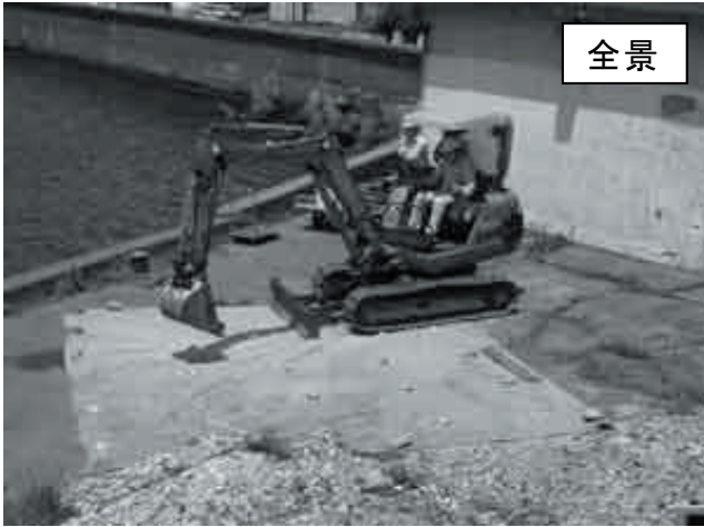
図-4.55 平面指示動作実験 搭乗操作状況
