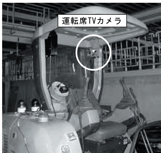
図-4.60 運転席TVカメラ設置状況と映像
