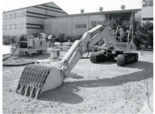
図-4.86 水中バックホウ全景
