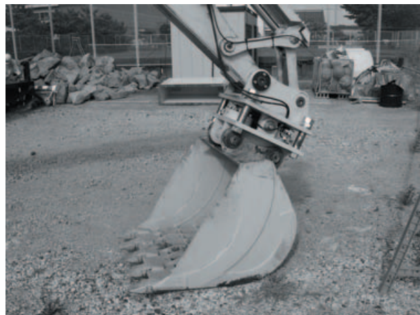
図-4.88 水中用反力センサアタッチメント
