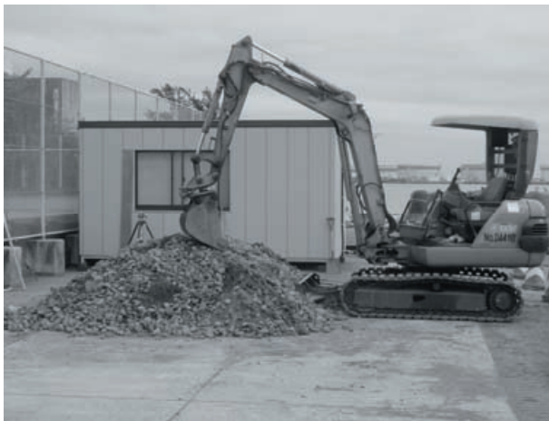
図-4.82 無視覚遠隔操作実験状況
