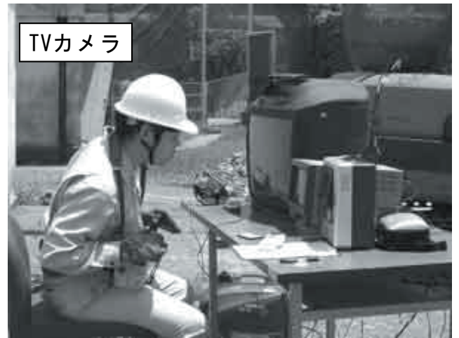
図-4.56 平面指示動作実験 無線リモコン操作状況
