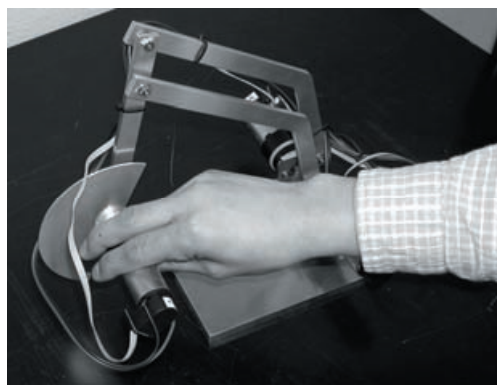
図-4.17 パンタグラフマニピュレータ
