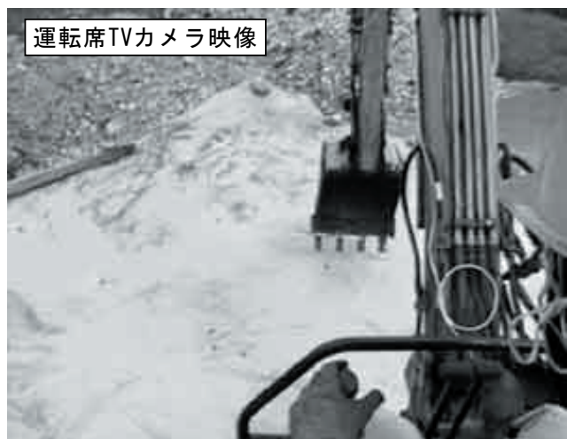
図-4.60 運転席TVカメラ設置状況と映像
