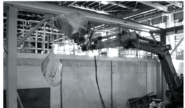
図-4.49 反力センサ特性試験 (荷重50kg, 姿勢220°)
