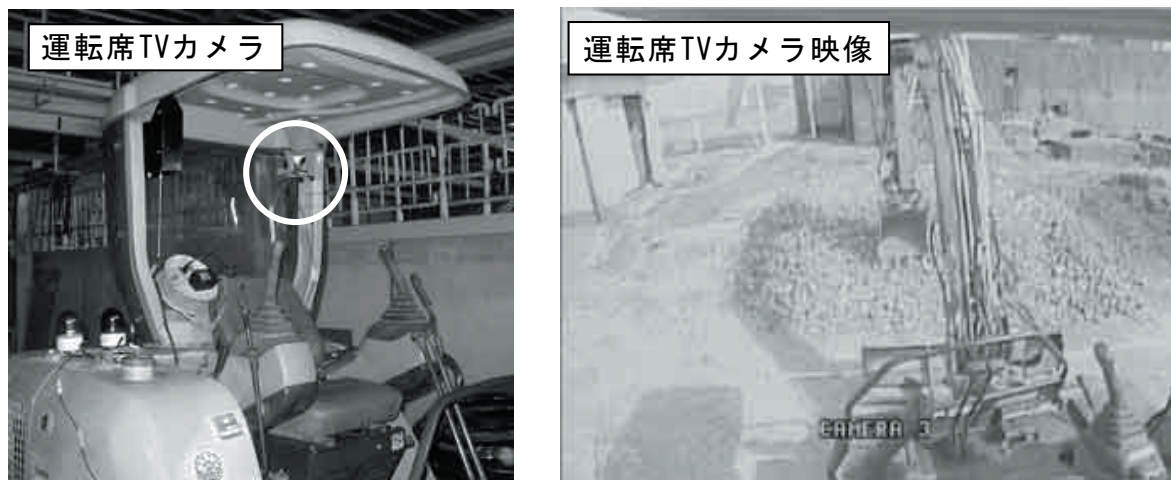
図-4.69 運転席TVカメラ設置状況と映像
