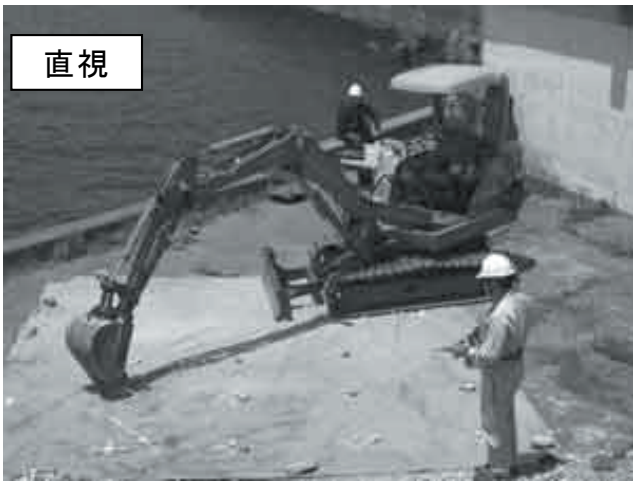
図-4.56 平面指示動作実験 無線リモコン操作状況
