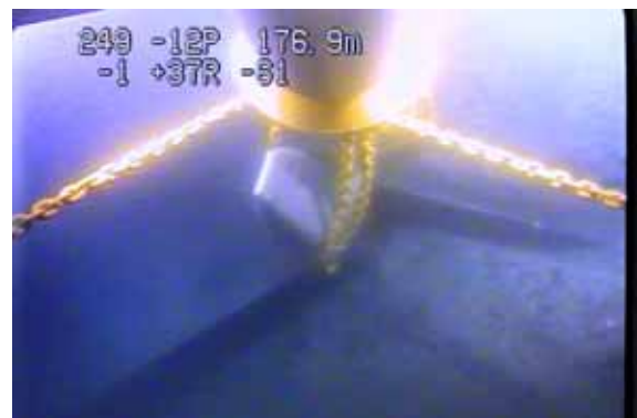
写真-26 水中翼の拘束状況
