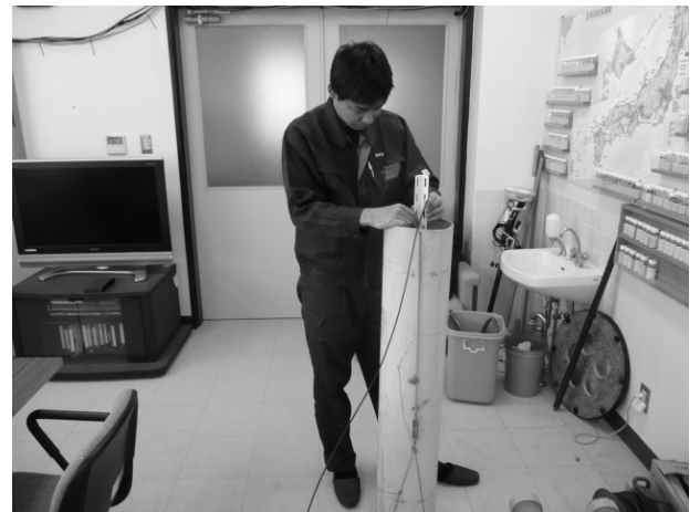
写真-D.4 小型水圧計のキャリブレーション
