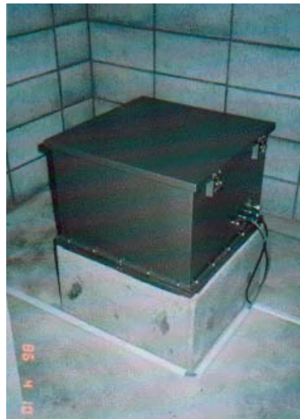
図-7 一体型の ERS-F 型強震計
