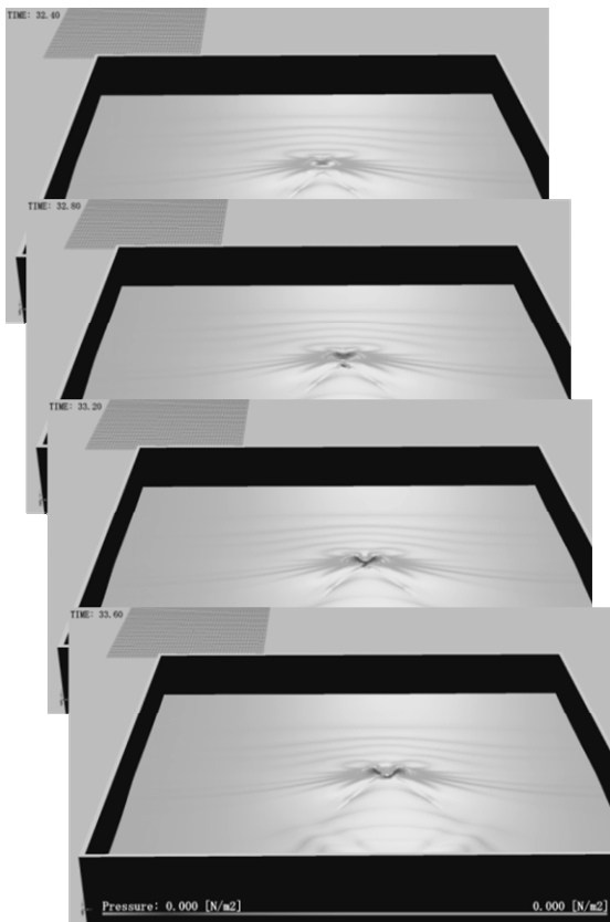
図-2.14 三角潜堤の上での碎波変形計算結果
