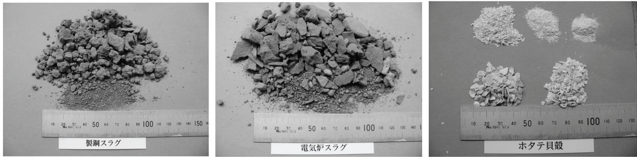
(a) 製鋼スラグ (b) 電気炉スラグ (c) ホタテ貝殻
