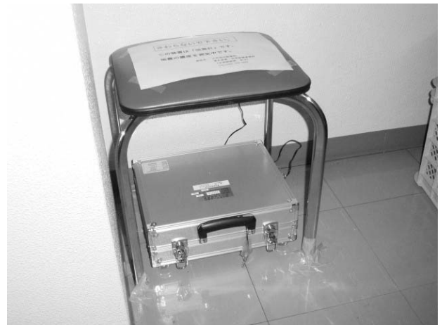
写真-A.2 事務所における地震計設置状況
