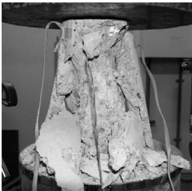
写真-3 荷速度 D3 の圧縮破壊状況
