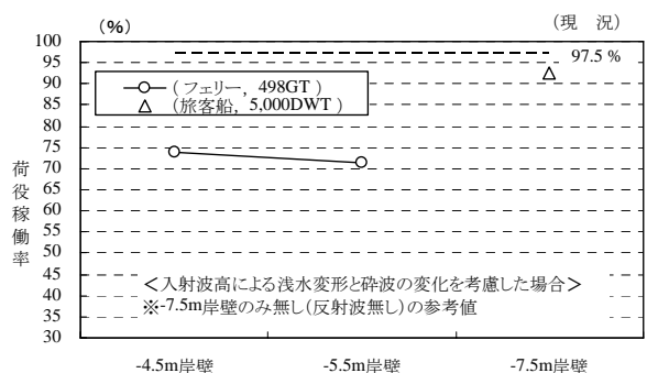
図-5.2.17 対象岸壁の港内静穏度（S港） （入射波高を変化させた場合）（標準解析法）
