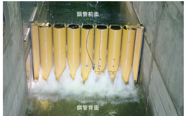
写真-4.1 鋼管背後から見た透過波の状況（津波対象波）
