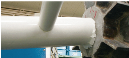
写真-10 破壊状況（支柱基材補強①）
