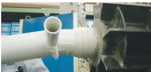
写真-11 破壊状況（支柱基材補強②）
