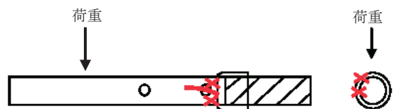
図-12 破壊箇所のイメージ図（支柱内部補強②） （赤線および赤×は亀裂，ひび割れ箇所を示す）
