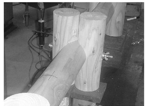
写真-1 試験体の交差部の組み立て状況
