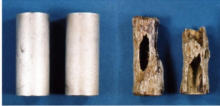
a) 通電試験片(防食片)    b) 不通電試験片(無防食片)
