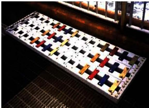
写真-D.71 栈 300 金属溶射防食工法(表-C.76 参照)
