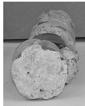
写真-3.9 コアの杭側表面の状態 (写真-B.13 参照)
