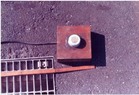
写真-B.16 亜鉛基準電極の外観（写真-4.1 参
