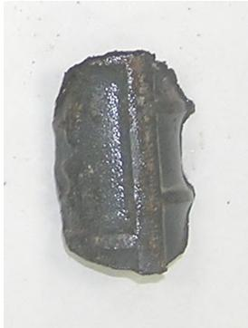
写真-B.11 内部鉄筋の状態
