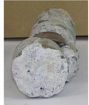
写真-B.13 コアの杭側表面の状態
