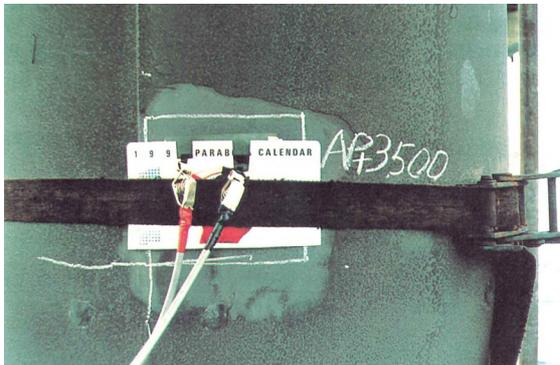
写真-B.3 絶縁抵抗の測定状況 (写真-2.1 参照)
