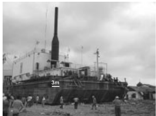
写真-5.4 海岸から3km離れた内陸まで流された発電用バージ (撮影：富田)
