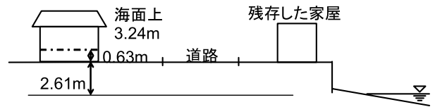
図-3.6 海側に建物が残存した場所の痕跡高さ
